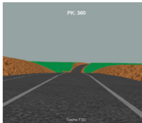
Figura 4: Visualización de un tramo con inconsistencias del diseño geométrico – falla de coordinación de alineamientos, que someten al conductor a riesgos.
